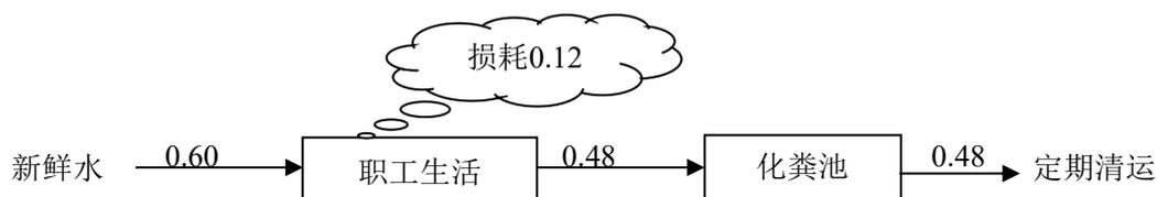
图 8 项目水平衡图 (单位: m<sup>3</sup>/d)
