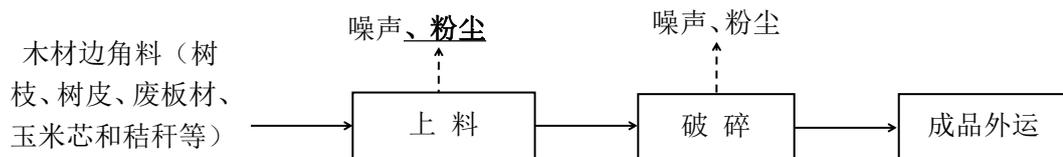
图 4 木渣工艺流程及产污环节图
