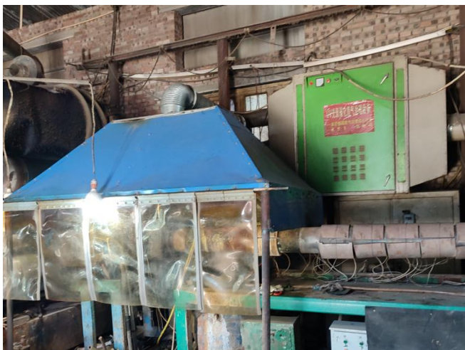
现有工程挤出工段配备的“UV 光氧催化+活性炭吸附装置”
