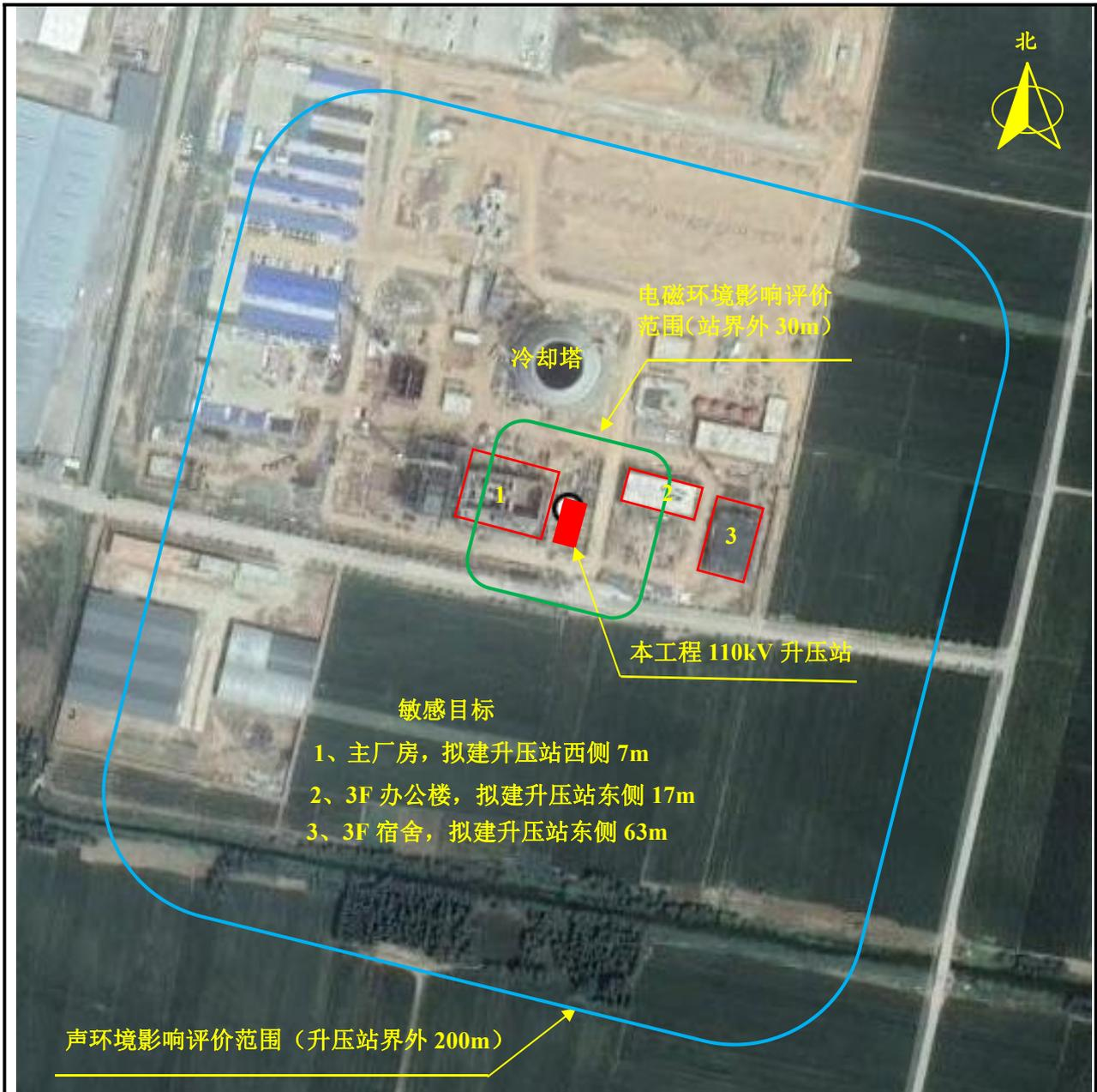
图 4-1 本工程 110kV 升压站与敏感目标相对位置关系卫星图
